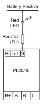
Fig. 7.5.7A - Alarm Wiring
