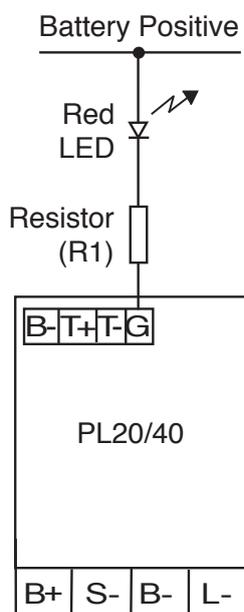
Fig. 7.5.7A - Alarm Wiring
